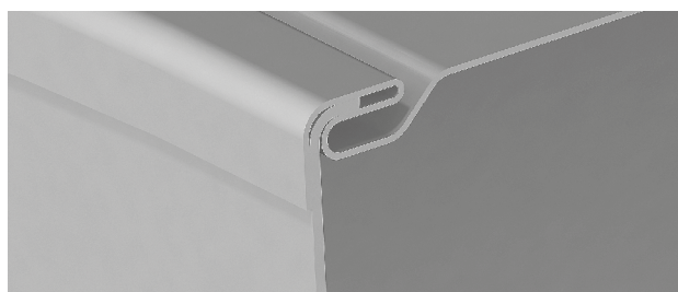
Рисунок 6. Сборка корпуса вентилятора на «питтсбургском фальце»
